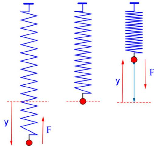
Aplicando la segunda ley de Newton ( $F_y = ma_y$ ) al sistema formado por la partícula de masa  $m$  y el muelle de constante elástica  $k$  tenemos:
